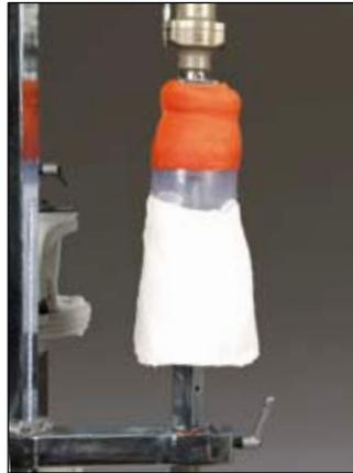
Testschaff im Übertragungsgerät 743A16 fixieren und mit einer Gipslonguette konisch verlängern.
