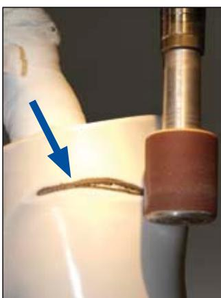
Vor dem Schönheitsguss (z. B. Dekostoff) Armierung im Schafrandbereich bis auf die PETG-Platte abschleifen, um eine Verbindung zwischen dem PETG und dem letzten Guss zu gewährleisten.
