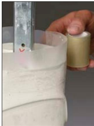
Nach dem Erkalten am Rand abschneiden. Absaugkanäle (im Gips) mit Plastaband 636K8 = 20 x 2 x 10 schließen. Vierkantröhr einschieben und Gips mit Orthocryl®-Siegelharz 617H21 isolieren.
